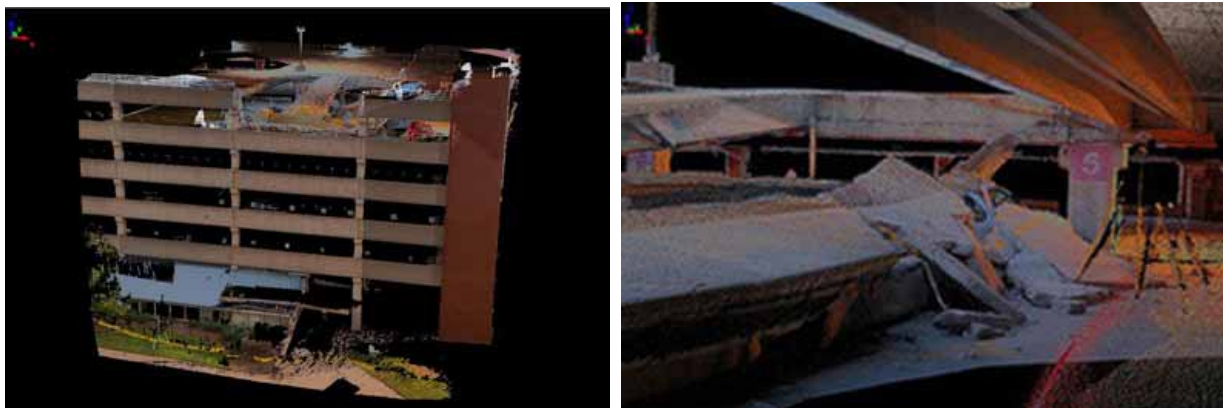
図2：駐車場ビル崩壊現場での3次元計測 出典：SparView Vol.3 No.14
