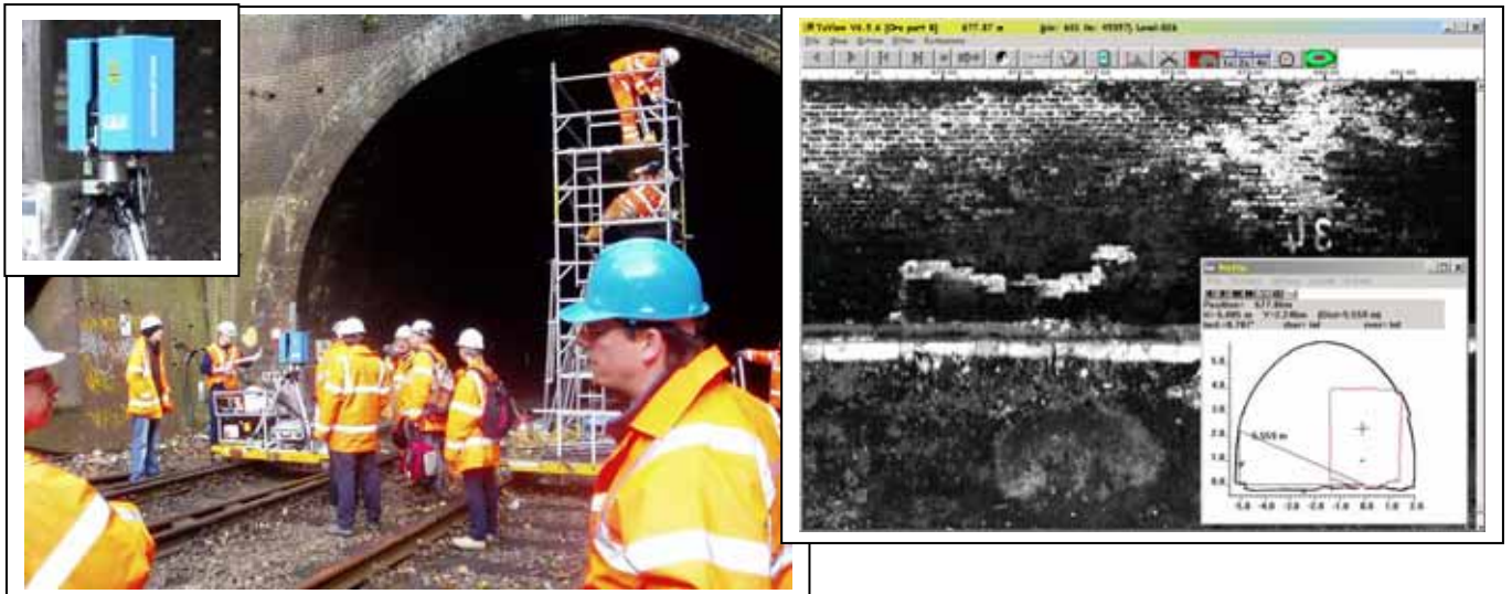
図8： ロンドン・クリスタルパレストンネルのレーザスキャンと計測されたトンネル側壁の膨張
