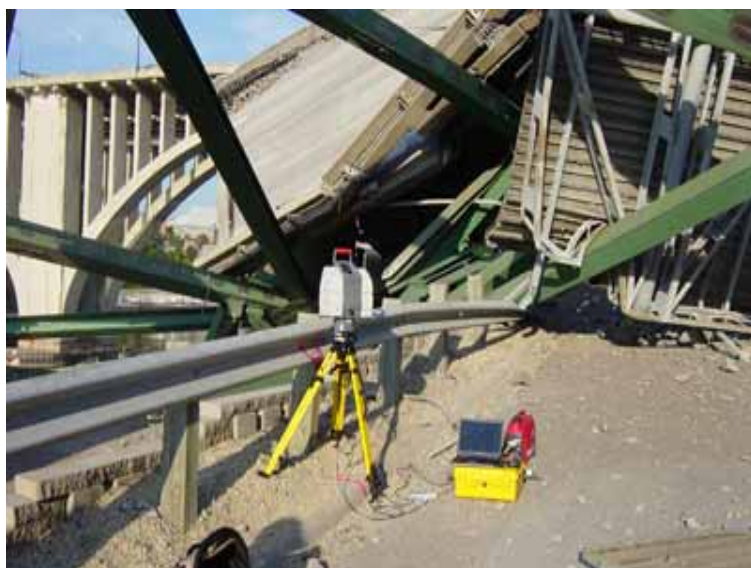
図1：ミネソタ州橋梁落下現場での3次元計測
