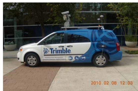
Trimble Riegl と Sick のレーザを搭載
