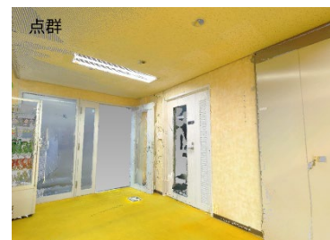
デジカメ写真から作成した テクスチャー付き3Dモデル
