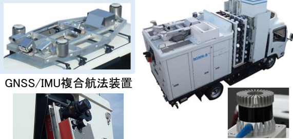
GNSS/IMU複合航法装置 2Dレーザースキャナ 3D LiDARを新規搭載
