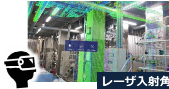
計測作業支援向けTLS点群MR表示
