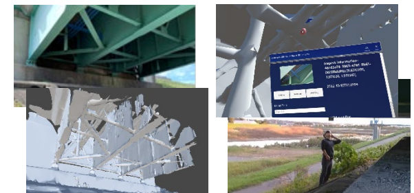
Hololensを用いたSLAMによる3D計測と 点検結果の3D登録
