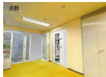
デジカメ写真から作成した テクスチャー付き3Dモデル
