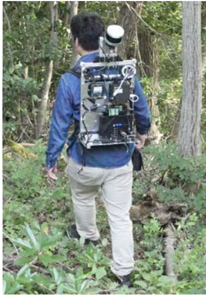
自作バックパック型MMS
