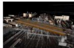
また、設計図面より作成した設計3Dモデル（施工対象物の3Dモデル）から設計形状・寸法調査を行い、工事の完成形や状況との照り付け、施工現場点を可視化することができます。
